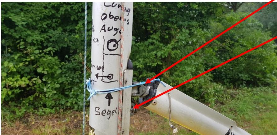
Der Großbaum wird in den Bolzen am Mast eingeführt.
