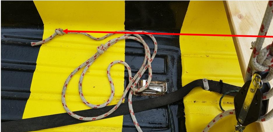
Die beiden Enden der Fockschot mit Achtknoten sichern, damit sie nicht durch die Ösen ausrauschen.
