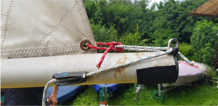
Unterliekstrecker durch Schäkel führen, spannen und an Klemme belegen.
