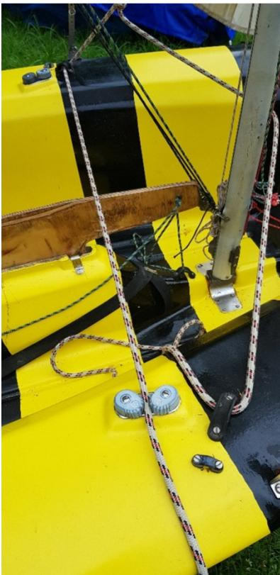
Die beiden Enden der Fockschot durch die Ösen und auf der gegenüberliegenden Seite durch die Klemmen führen.
