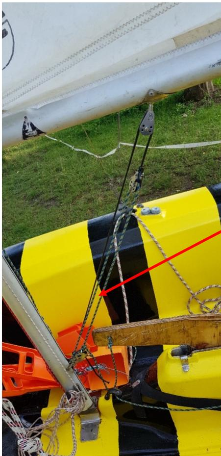
Baumniederholer zur Stabilisierung des Großbaums einhängen und spannen.
